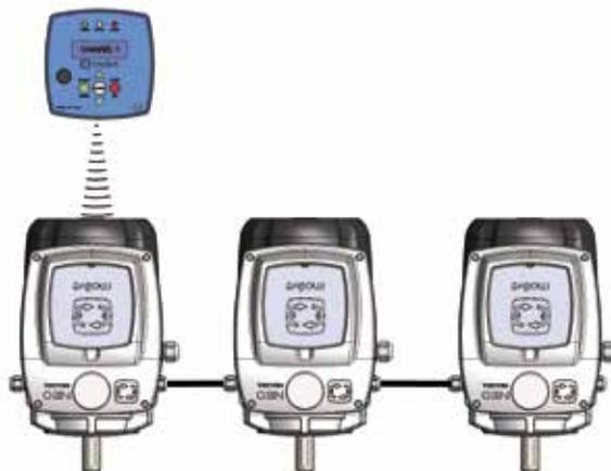
È possibile ottenere un comportamento sincronizzato di 2-8 NEO-WiFi con una sola tastiera, collegandoli in modalità master-slave. Gli Slave possono funzionare anche senza tastierino, una volta che siano stati parametrizzati in connessione RS485.
